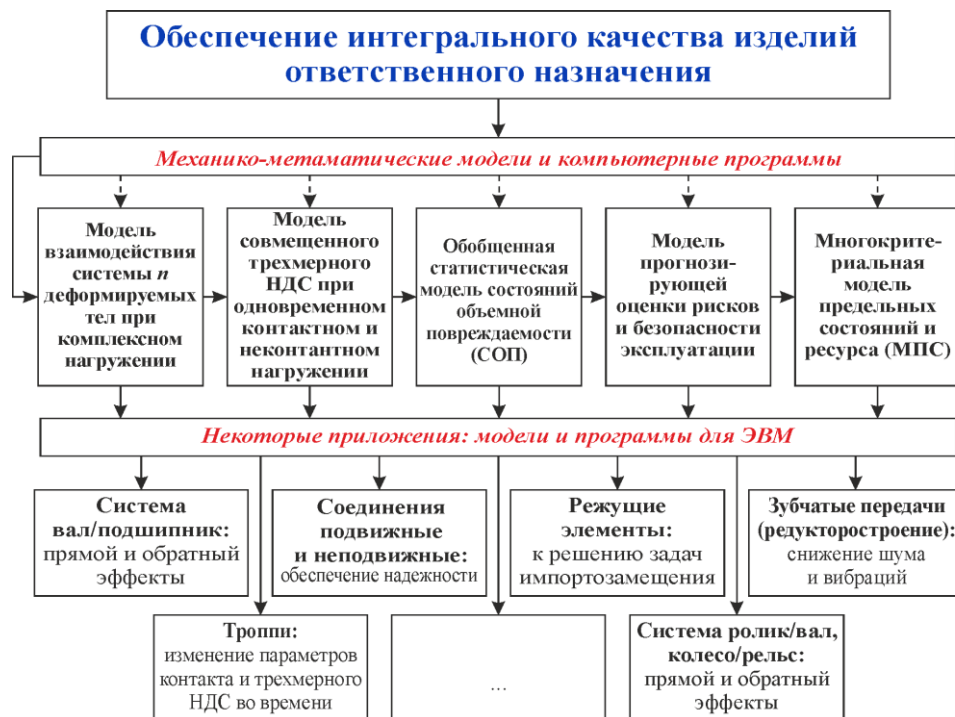
Рисунок 7. Методология последовательной постановки и решения задач трибофатики
